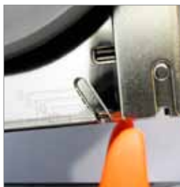
Ogranicznik głębokości papieru.
